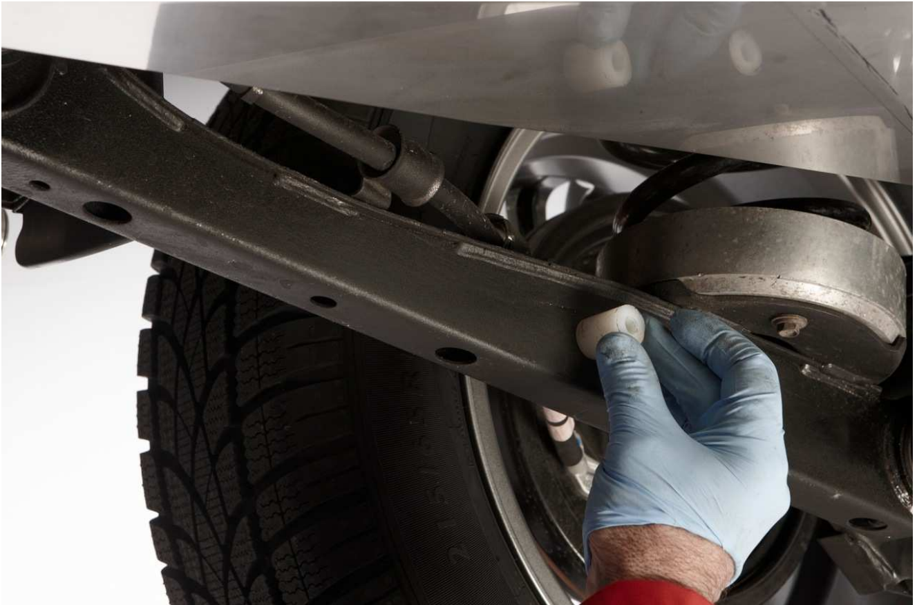
Posizionare le due boccole distanziali (in dotazione con la piastra) nel puntone posteriore; (vedi figura 1)
