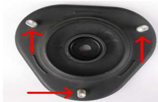
4 - Inserire le 3 viti in acciaio, fornite nel Kit, nel supporto superiore
