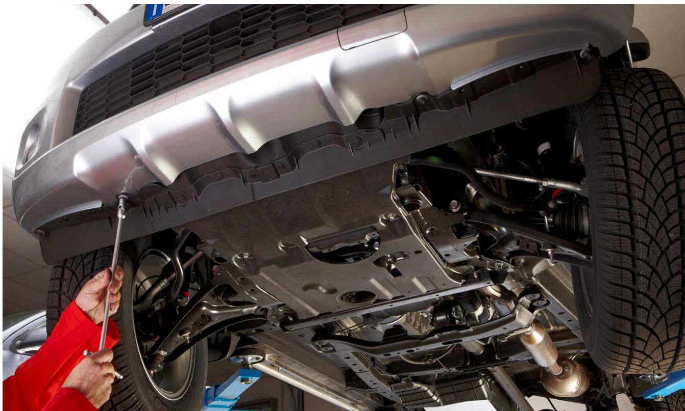
Rimuovere spoiler di plastica anteriore; (vedi figura 1)
