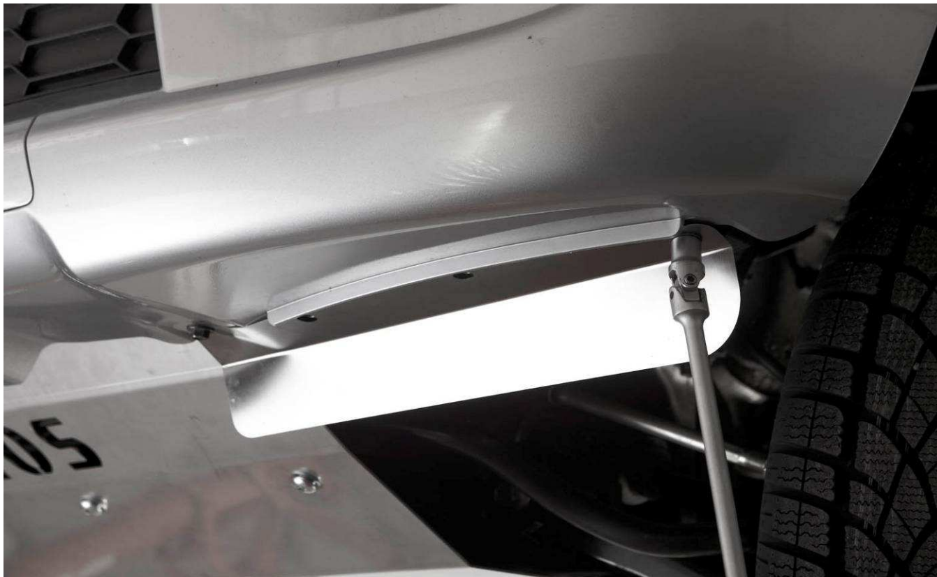
Posizionare i baffi deflettori in acciaio; (vedi figura 2)
